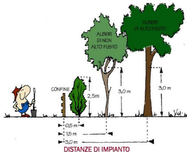
Per confine stradale s'intende il ciglio superiore della scarpata del fossato stradale verso la proprietà privata. In situazioni particolari come ad esempio in prossimità di incroci e/o curve stradali valgono specifiche norme del codice della strada che impongono il rispetto dell'angolo di visibilità, quindi ogni situazione andrebbe valutata singolarmente.
